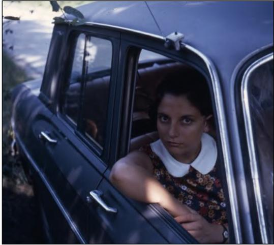
Noter l'antenne extérieure fixée sur la gouttière. A l'intérieur un câble coaxial se branchait dans une prise de mon transistor. C'était nettement moins cher que de faire installer un autoradio dans la voiture.
